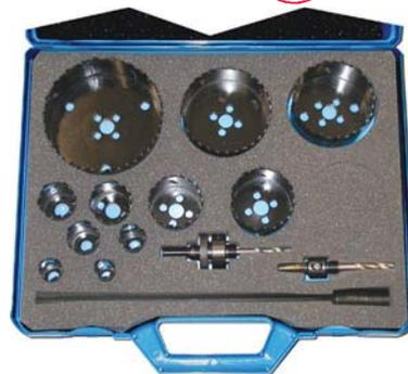
Tipo con denti rivestiti di grani in metallo duro, professionale. Da usare su trapani portatili e a colonna. Permettono tagli aggressivi ma uniformi, veloci e leggeri. Lunga durata del dente e della affilatura. Per forare tutti i tipi di materiali abrasivi e duri come fibre di vetro, carbonio, kevlar, grafite, cementi, marmi, graniti, ceramiche, ghise ecc. Profondità della sega a tazza mm 40.
